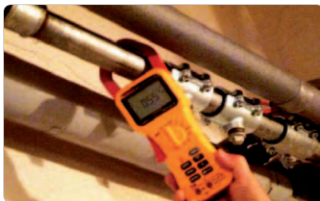
Obr. 6 Nameraná hodnota bludného prúdu na potrubí TUV
