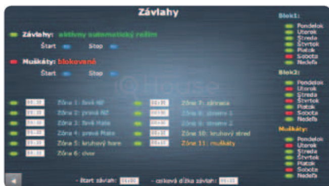
Obr. Ukázka webové stránky pro nastavování parametrů zavlažování všech 11 zón zahrady a časových programů. Jednoduše tak nastavíme optimální množství a frekvenci závlahy například pro muškáty.
