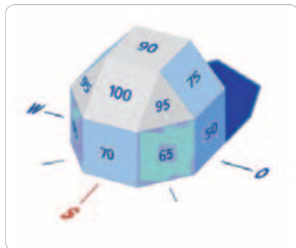
Obr. Účinnosť fotovoltaických panelov v závislosti od orientácie
